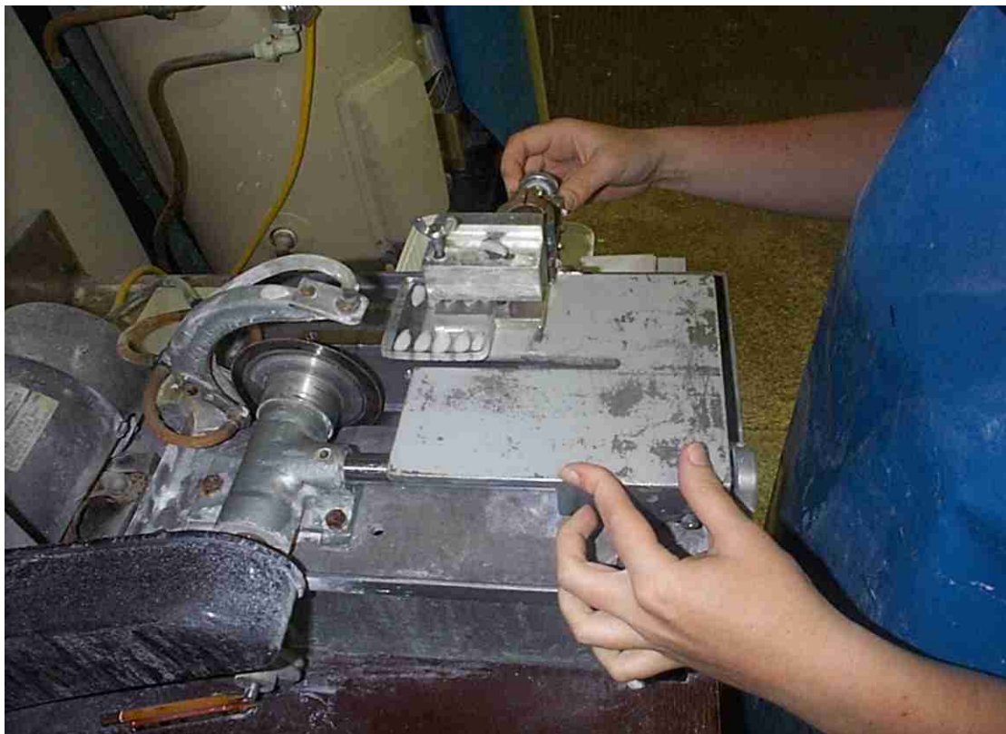
2. 改良を加えたジェマスタ (Gemasta™) 社の鋸で切片を作成している様子。出展：オーストラリア、中央年齢査定施設、カイン・クルジック・ゴラブ
