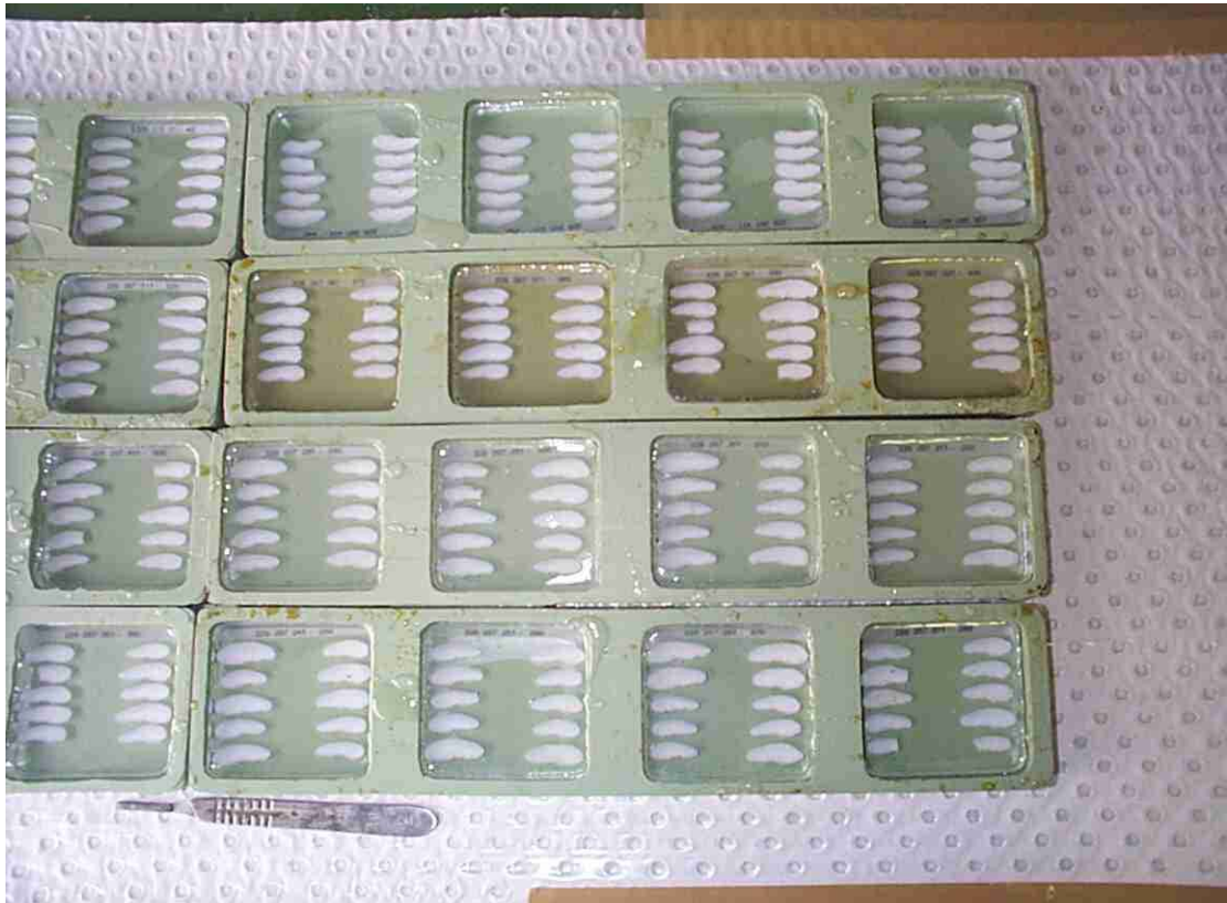
1. 耳石をポリエステル樹脂に包埋するシリコンの型。出展：オーストラリア、中央年齢査定施設、カイン・クルジック・ゴラブ (Kyne Krusic-Golub)
